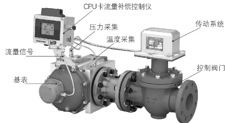
图2 流量计结构原理图
