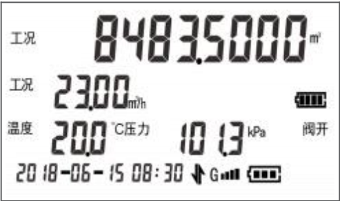
图 5 显示有流量、温度、压力和总量。其中流量和总量表示工况流量和工况总量。
