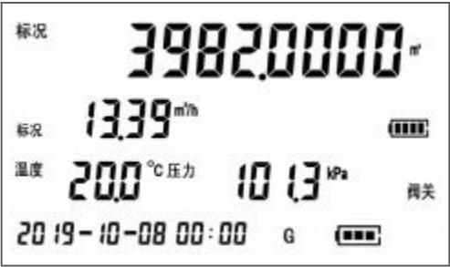
图 4 显示有流量、温度、压力和总量。其中流量和总量表示标况流量和标况总量。
