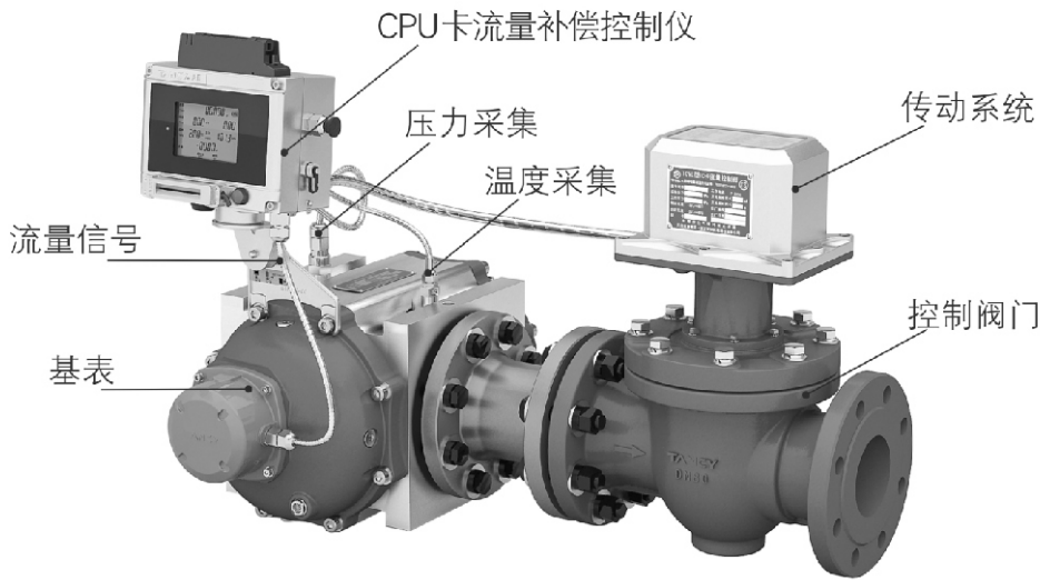
图2 流量计结构原理图
